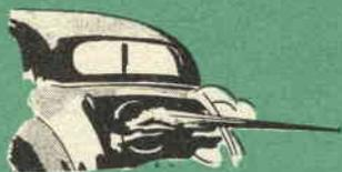
merosi inconvenienti, come: ammaccature, irregolarità di aderenza o di spessore della vernice, ecc. Le cause possono essere: preparazione insufficiente delle parti metalliche; persistenza delle macchie di grasso, di olio o di altre materie estranee; applicazione di uno strato troppo denso su sottostrati non ancora asciutti.
