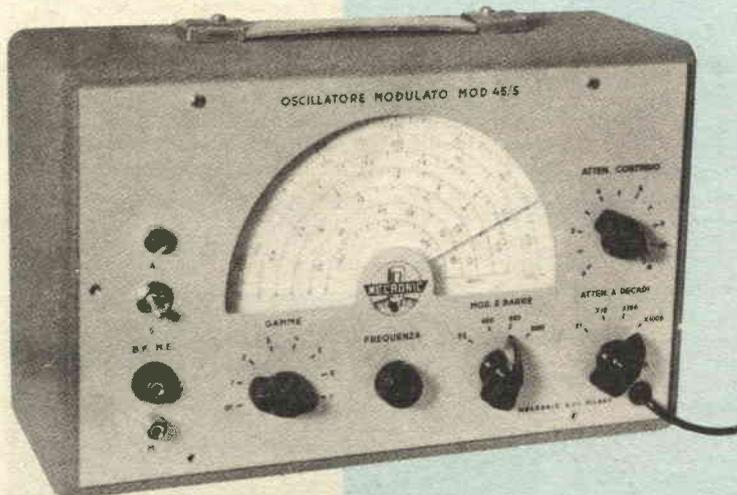
**Da 270 KHz a 165 MHz in 7 gamme, tutte in fondamentale. Fino a 310 MHz in seconda armonica. Funziona anche come generatore di barre. La scatola di montaggio, completa, corredata di fascicolo di istruzioni dettagliatissimo viene fornita franco di porto ed imballo dietro versamento di L. 14.000 sul c/c.p. 1/18253 intestato alla SEPI Via Ottorino Gentiloni - Fabbricato G. (Valmelaina) - ROMA**
