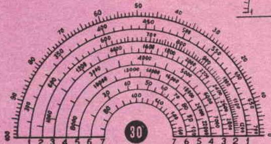
le relative scale del quadrante. Prendiamo il diagramma che si riferisce alla gamma 1, e tiriamo delle verticali in corrispondenza dei punti (1-2-3 ecc.), in cui la curva interseca i valori interi della frequenza (300-350-400 ecc.). Si trovano dei valori (91-74-60 ecc.) che corrispondono alle posizioni dell'indice dell'oscillatore per detti valori interi di frequenza (figura 26).
